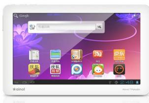
Планшетный компьютер Novo 7 Paladin от китайского производителя электронной техники Ainol, работающий на операционной системе Андроид версии 4.0 ICS, с емкостным 7 дюймовым дисплеем.
